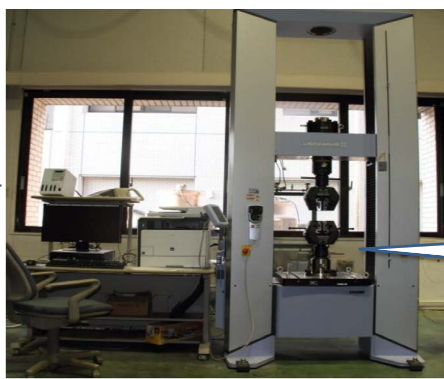
押し込み硬さ試験によるN値との相関調査
